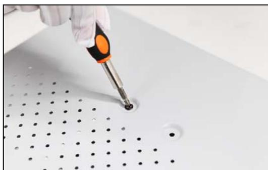
Figura 2. 4 Installazione HDD
