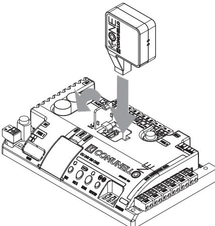
• Verificare l'accensione del led di segnalazione laterale (modulo attivo e pronto alla comunicazione). Procedere con l'associazione della rete WiFi generata dal modulo (es. SSID: comunelloWiFi\_ONE#04081230) al proprio dispositivo mobile. Dal menu di configurazione del proprio dispositivo, cercare le reti WiFi disponibili e selezionare la rete "comunelloWiFi\_ONE#..." (il codice numerico dopo il carattere # è variabile).
