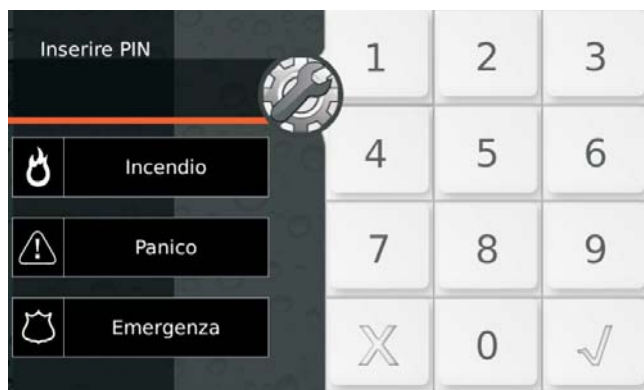
Figura 24 Etichette di Fabbrica dei Super Tasti della Tastiera Touch.
